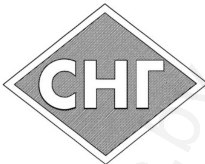
Рисунок 11.1. Образец опознавательного знака для транспортных средств категорий М 2 и М 3 , использующих в качестве топлива сжиженный нефтяной газ (СНГ) или компримированный природный газ (КПГ)
