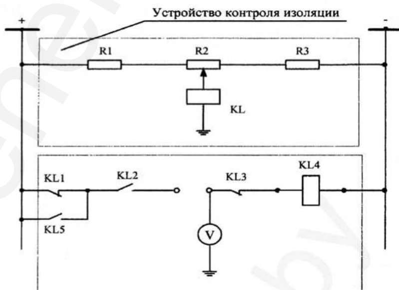
Рисунок 8 – Схема отыскания неисправности с помощью вольтметра
