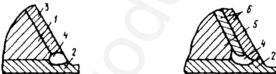
Рис. 3. Схема выполнения предварительной наплавки кромок деталей из двухслойных сталей с плакирующим слоем, содержащим ниобий: 1 - углеродистая или кремнемарганцовистая сталь; 2 - плакирующий слой; 3 - однородная наплавка, выполненная сварочными материалами по табл. 4; 4 - разделительный валик; 5 - легированная сталь; 6 - двойная наплавка, выполненная сварочными материалами по табл. 4
