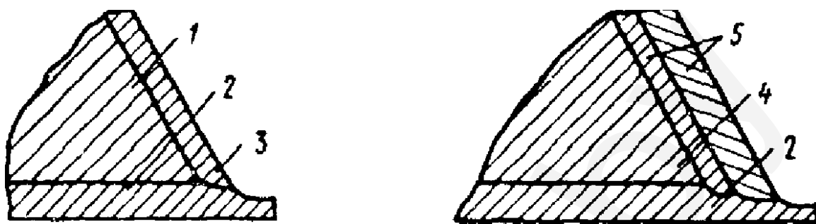
Рис. 2. Схема выполнения предварительной наплавки кромок деталей из двухслойных сталей с плакирующим слоем, не содержащим ниобий: 1 - углеродистая или кремнемарганцовистая сталь; 2 - плакирующий слой; 3 - однородная наплавка, выполняемая сварочными материалами по табл. 4; 4 - легированная сталь; 5 - двойная наплавка, выполняемая сварочными материалами по табл. 4
