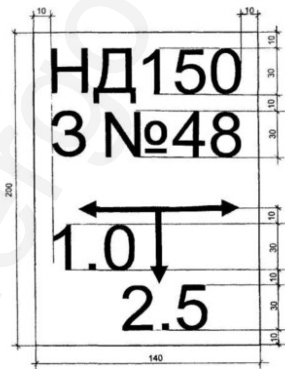
Рисунок 2. Газопровод низкого давления, диаметр – 150 мм, задвижка – № 48.
