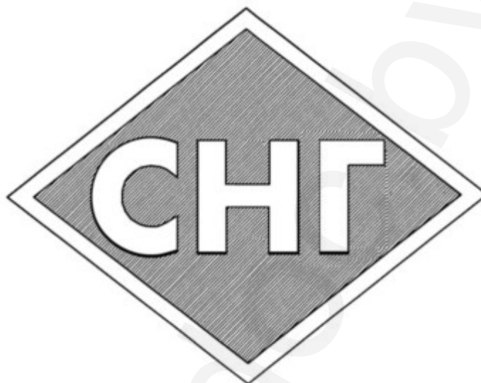
Рисунок 11.1. Образец опознавательного знака для транспортных средств категорий М 2 и М 3 , использующих в качестве топлива сжиженный нефтяной газ (СНГ) или компримированный природный газ (КПГ)
